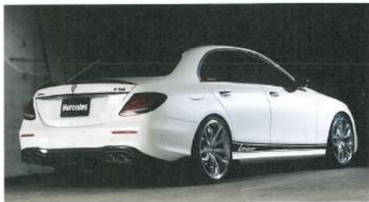
純正形状を生かしたカーボンリップスポイラー 3ピース構成となるフロントリップスポイラーはベースデザインを引き継ぎながらも、スポーティさを強調。シンプルではあるがカーボン素材を採用し、ボトムラインを生かしたロリンザーらしい仕上がりになっている。
